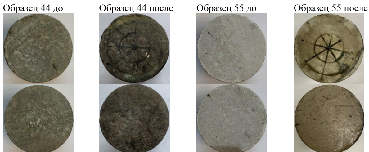
Рисунок А.3 – Фотографии образцов 44 и 55 до и после закачки кислоты
