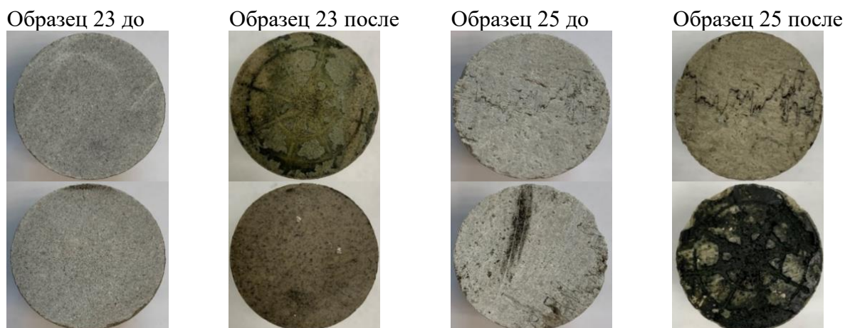
Рисунок А.2 – Фотографии образцов 23 и 25 до и после закачки кислоты
