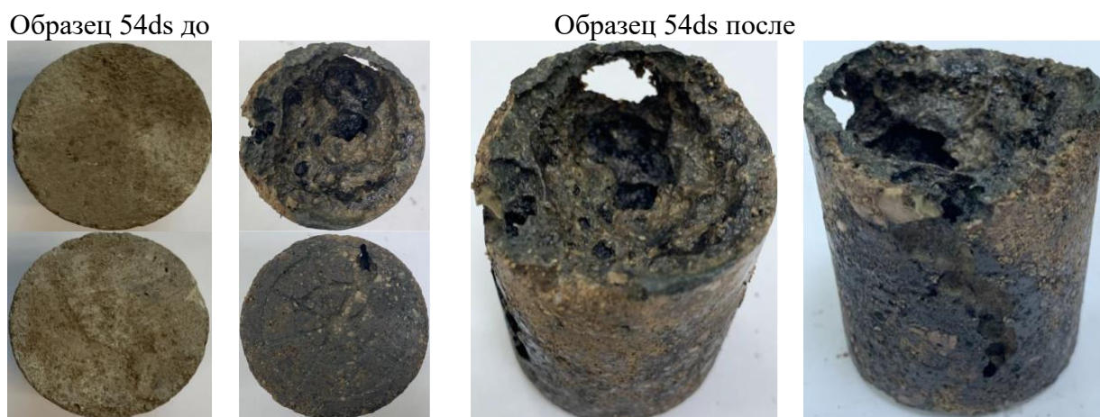
Рисунок А.5 - Фотографии образца 54ds до и после закачки кислоты
